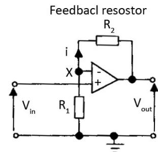
Figure 32 Non inverting
